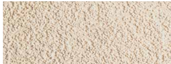
Штукатурка Ceresit СТ 137, зерно 2,5 мм, получена путем затирания пластиковым полутерком (теркой).
