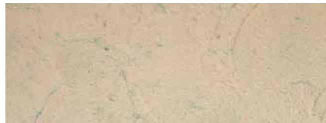
Штукатурка Ceresit СТ 36, фактура получена путем нанесения металлическим шпателем с приданием матовой поверхности губкой.
