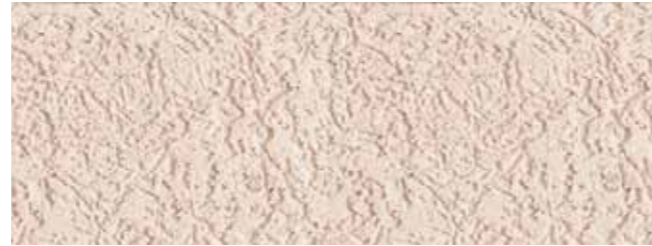
Штукатурка Ceresit СТ 35, зерно 3,5 мм, получена путем круговых затираний пластиковым полутерком (теркой)
