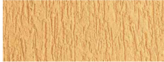
Штукатурка Ceresit СТ 35, зерно 3,5 мм, получена путем круговых затираний пластиковым полутерком (теркой) в одном направлении
