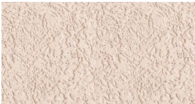
Штукатурка Ceresit СТ 35, зерно 3,5 мм, получена путем круговых затираний пластиковым полутерком (теркой)
